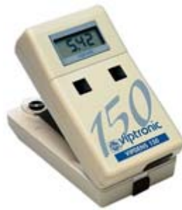
Figura 10: Densitómetro de transmisión
