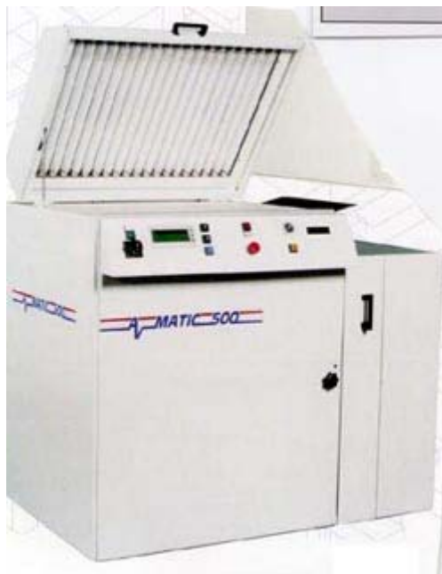
Figura 5: El procesado de una plancha flexo tiene una mezcla de insolado y grabado
