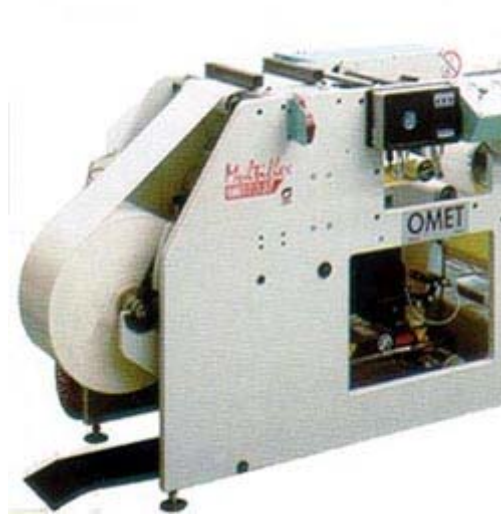
Figura 8: El desbobinador sirve para colocar la bobina a imprimir
