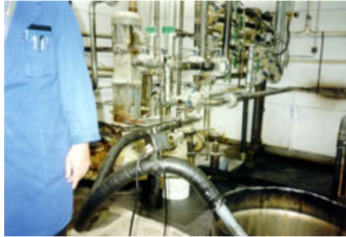
Figura 15: Conducciones componentes tintas depósito hélice
