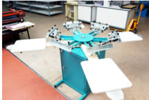
Figura 15: Serigrafía carrusel manual
