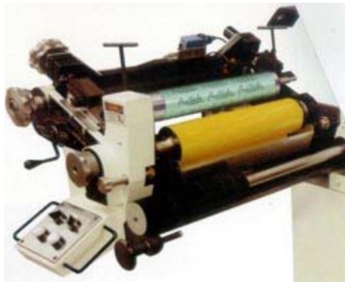
Figura 9: El anilox es el elemento fundamental de entintado
