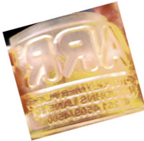
Figura 4: Las planchas fotopoliméricas son actualmente la principal superficie de impresión en flexografía
