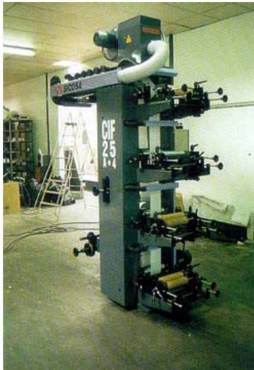
Figura 13: La máquina en torre tiene los cuerpos impresores situados uno encima de otro
