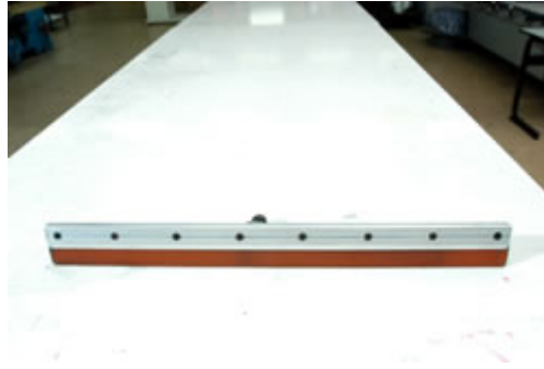
Figura 13: Serigrafía rasqueta maquina
