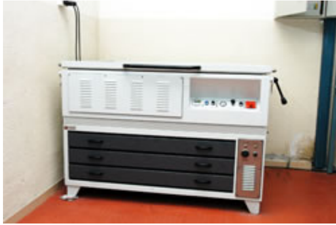
Figura 9: Insoladora de pantalla
