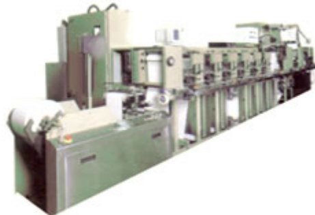
Figura 15: La rotativa en línea tienen los cuerpos impresores independientes
