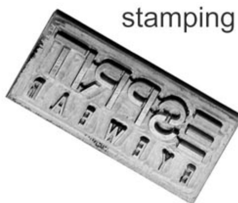
Figura 19: Stamping forma tipográfica.
