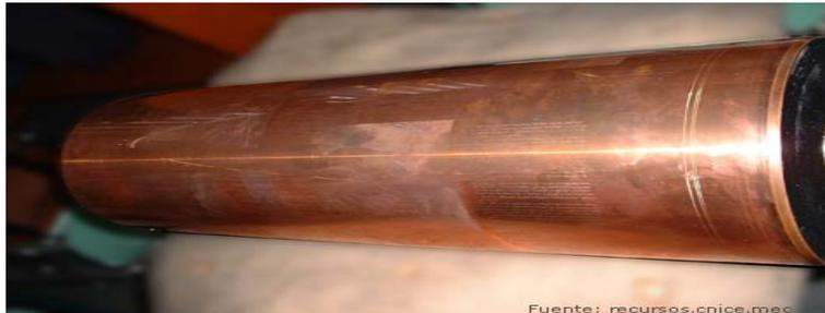
es decir, las zonas impresoras constituyen un hueco en la superficie del cilindro mientras que las zonas no impresoras constituyen la superficie exterior de dicho cilindro.
