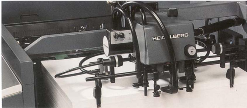
adaptables a diversos tamaños de papel, el pliego es elevado desde la pila y se avanza hacia la mesa de marcaje con un mecanismo que asegura el paso de un solo pliego. Para garantizar un perfecto recorrido del pliego sobre la mesa de marcar es necesario un perfecto marcado.
