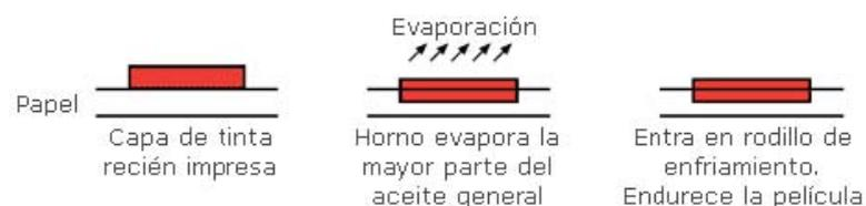
Fig. 15: proceso de secado de tintas por evaporación.
